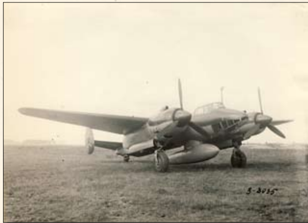
Летные испытания летающей лаборатории ТУ-2ЛЛ № 40/56. ЦИАМ. 1948 г.
