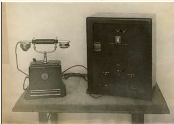
Система связи и сигнализации диспетчерского управления такси г. Москвы. Опытный образец пульта диспетчерского управления одной стоянкой.
